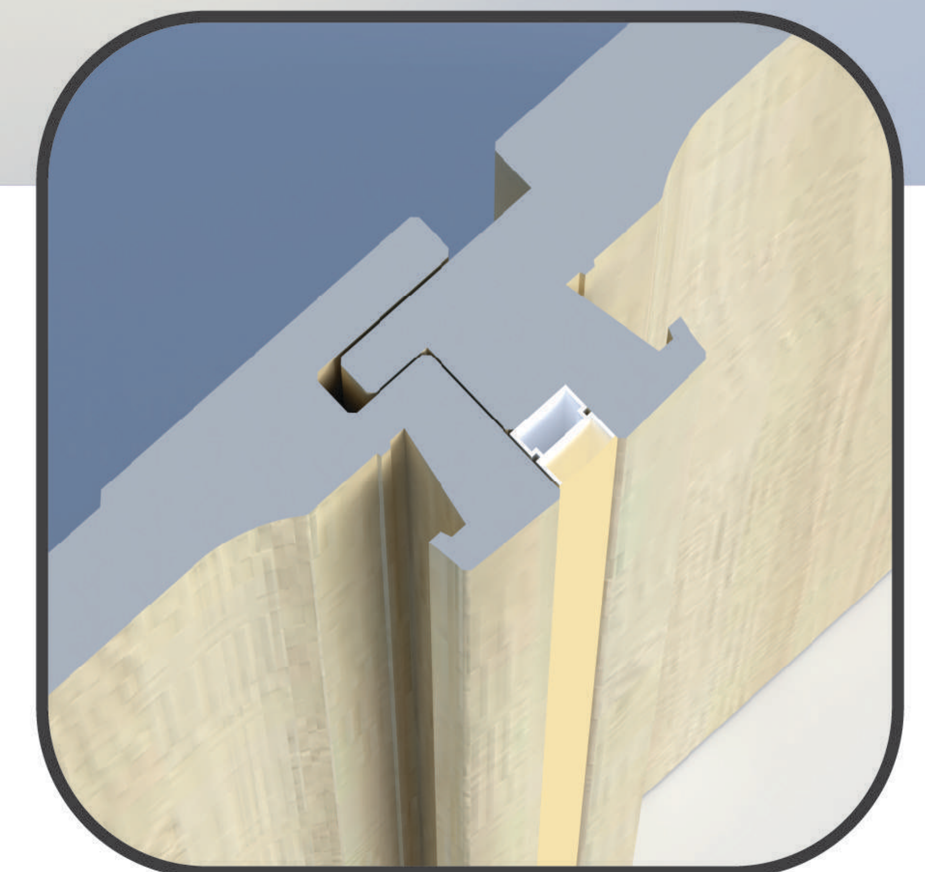
② ไฟ LED striped light ติดในร่องด้านหน้า
