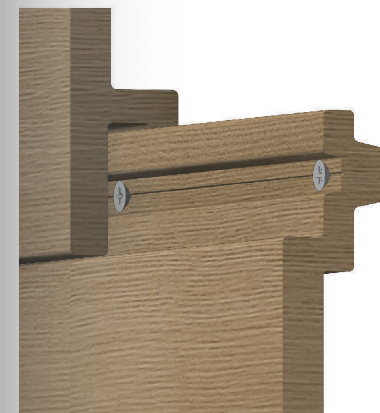
ยึดแผ่นด้วยสกรูแบบโครงเคร่าหรือพั้งปูน
